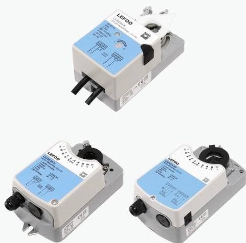
LFZ02/04/06/08/16/24/32/40系列电动风阀驱动器采用进口直流电机/无刷电机为该类产品提供动力部分,可提供2NM、4NM、6NM、8NM、16NM、24NM、32NM、40NM的扭矩。该产品可直接应用于风系统,水系统的角行程控制,可实现电压0(2)-10V 电流0(4)-20毫安的信号控制,并提供相互间可以转换的电流或者电压信号反馈。安装简便,可轻松固定在方轴,圆轴或其他形状的风阀连接轴上,该产品寿命长,噪音低,并可实现多功能智能控制。全系列产品均带手动操作功能。产品防护等级Ip54,稳定高效,有全称过载保护功能,全系列产品带手动限位。
